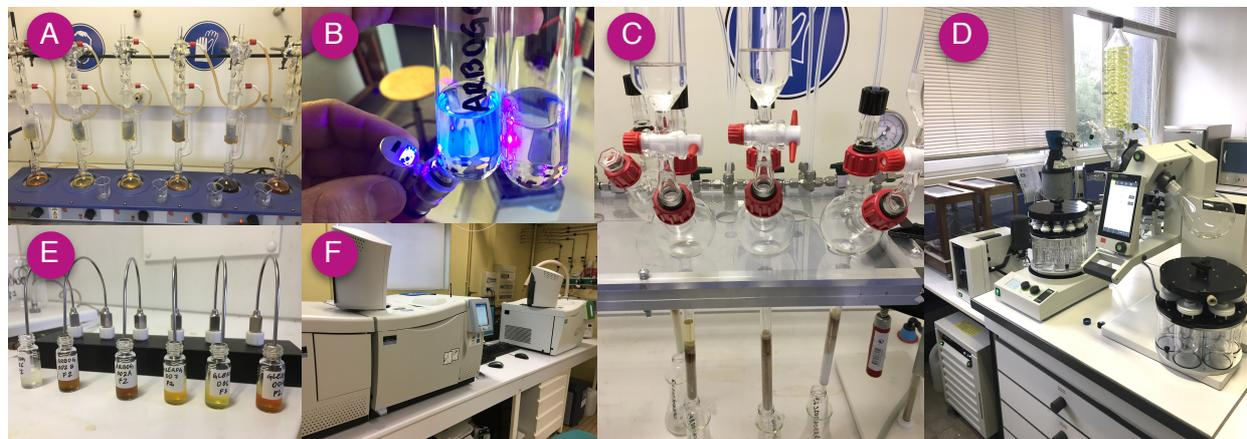
A) Rampe Soxhlet utilisé pour l'extraction de la MO soluble des substrats, B) Comparaison de fractions, les composés aromatiques (à gauche) fluorescent sous effet du rayonnement uv, C) chromatographe flash multi-échantillons conçu et réalisé par Dr. Melesio Quijada, D) unité d'évaporation rotative multi-échantillons, E) Système d'évaporation sous flux d'azote, F) GC/MS à gauche GC avec un détecteur à ionisation de flamme (FID) à droite.
